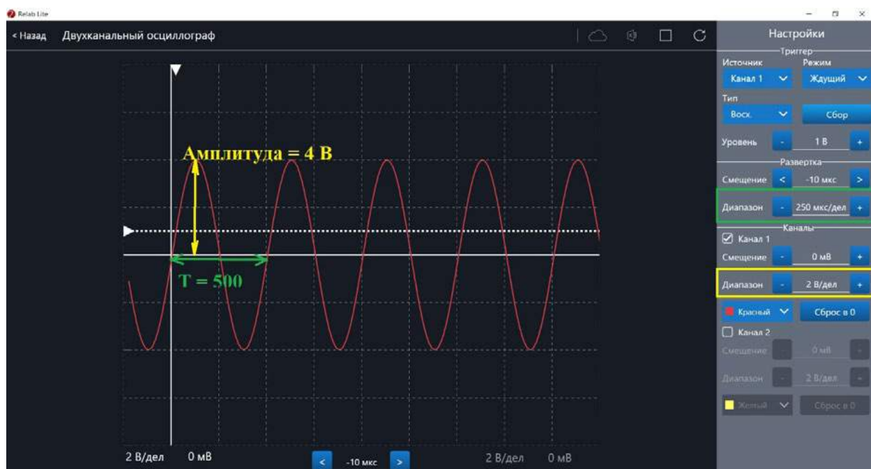
Рис. 42. Определение параметров осциллограммы
