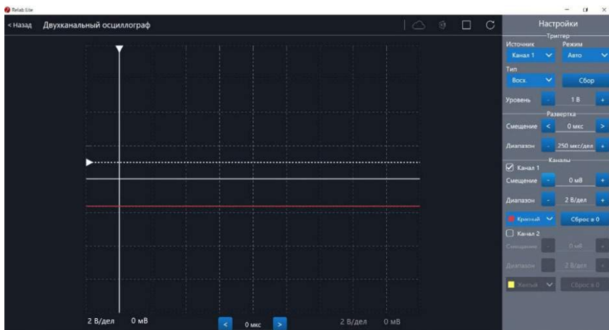
Рис. 40. Сигнал с ненулевым смещением
