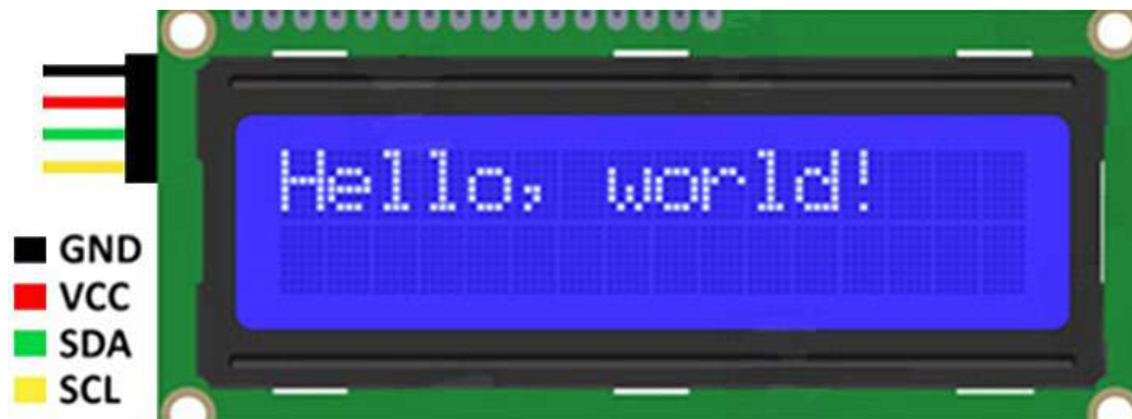
Рис. 1. Подключение модуля ЖКИ к Ардуино
