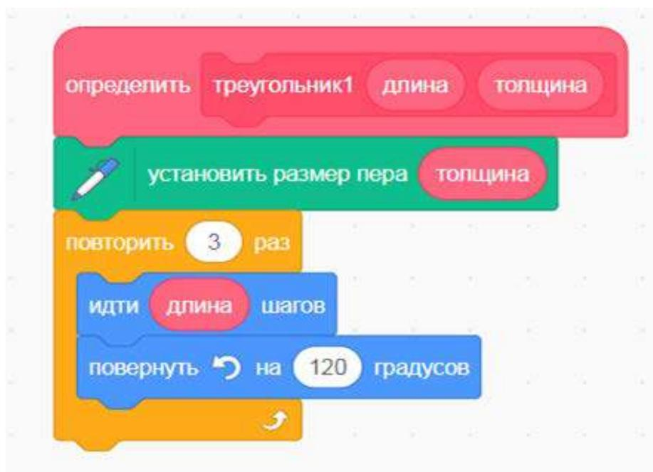
**Рис. 142.** Вид скрипта для создания нового блока
