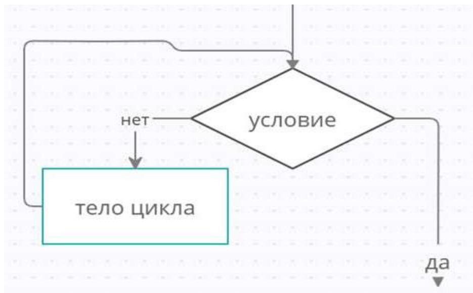
Рис. 127. Блок-схема цикла
