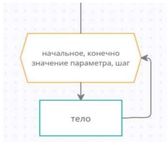
**Рис. 58.** Блок-схема цикла с параметром
