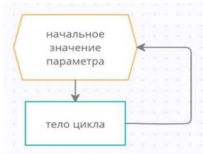
Рис. 124. Блок-схема цикла
