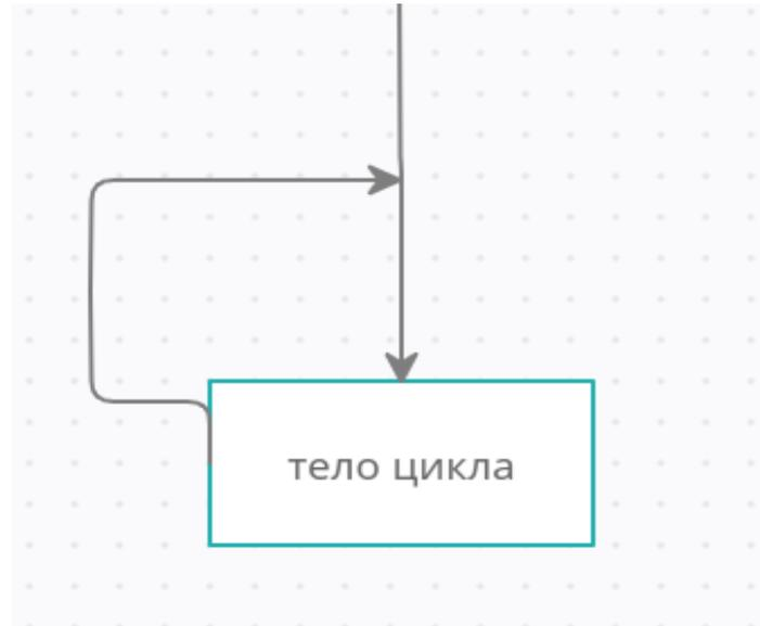
Рис. 126. Блок-схема цикла
