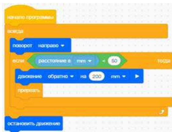
Рис. 30. Программа для демонстрации работы цикла прерывания
