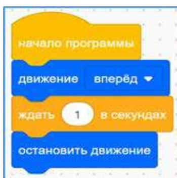
**Рис. 18.** Пример программы с использованием блока **Ожидания**
